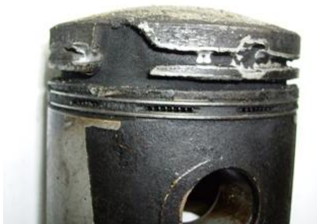
Рисунок 2 – Разрушение поршневой канавки
