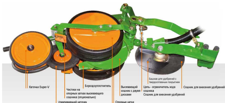
Рисунок 4 - Посевной агрегат сеялки EDX
