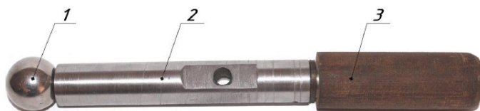
Рисунок 2 – Державка с шаровым инструментом: 1– твердосплавный шар; 2 – толкатель; 3 – токоизолирующая втулка
