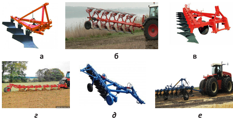
Рисунок 2 – Плуги: а, б – навесные; в, г – полунавесные; д, е – прицепные
