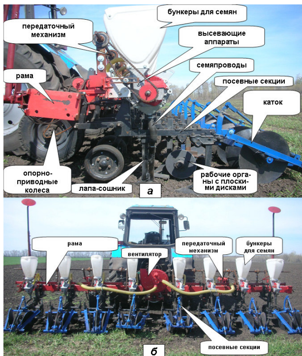
Рисунок 1 - Гребневая сеялка: а – вид сбоку; б – вид сзади
