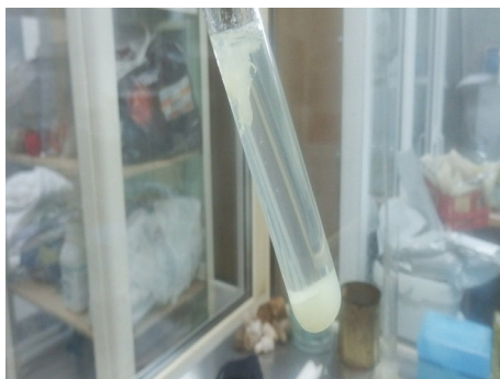
Рисунок 3 - Образование мутного альгината кальция при химической реакции растворимого хлорида кальция и прозрачного альгината
