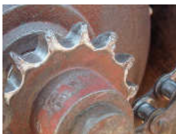
Рисунок 2 - Характер износа звездочек цепной передачи сеялки СЗУ – 3,6
