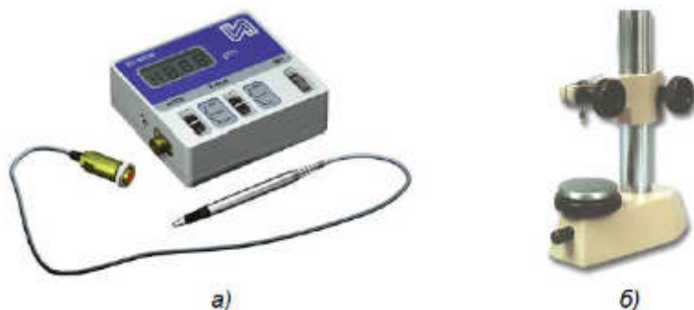
Рисунок 1 – Приборы для измерения диаметра плунжера: а) система измерительная портативная с индуктивным преобразователем БВ-6436; б) стойка универсальная для крепления индикаторных головок 15СТ-М
