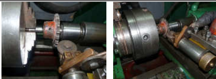
Рисунок 3 – Варианты ЭМЗ звездочек цепной передачи: а – ЭМЗ боковых поверхностей зубьев звездочки при I = 600 А, v = 100 мм/мин, P=30 Н; б – ЭМЗ зубьев звездочки по впадине при I = 3000 А, \tau = 3 с, P=30 Н
