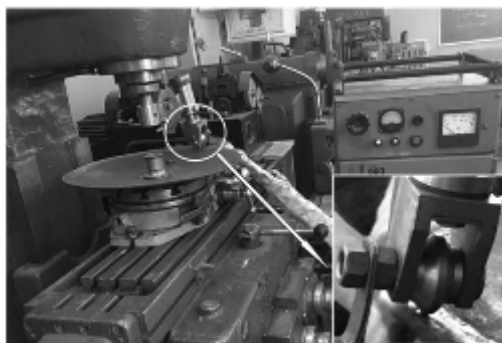
Рисунок 2 – Процесс ЭМЗ рабочей поверхности сферического диска
