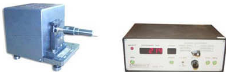
Рисунок 2– Прибор для измерения внутреннего диаметра втулок ПР7
