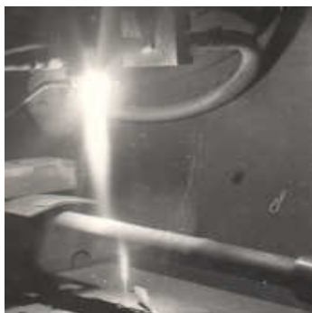
Рисунок 1- Процесс плазменного нанесения покрытия на шток гидроцилиндра.
