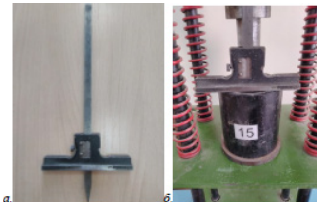
Рисунок 2 – Измеритель величины деформации образца почвы в гильзе–цилиндре: а – измеритель; б – определение величины деформации образца почвы в гильзе–цилиндре измерителем
