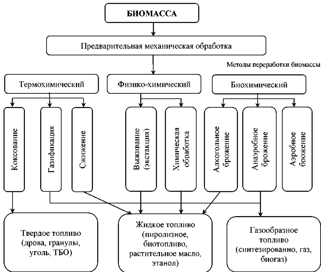
Рисунок 2 – Методы переработки биомассы в биогаз
