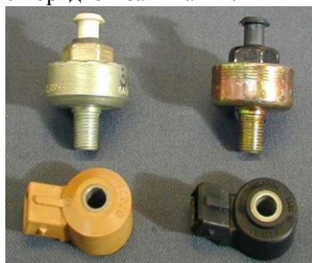
Рис. 177 – Внешний вид и устройство датчика детонации
