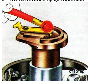
Рис. 203 - Проверка изоляции ротора распределителя
