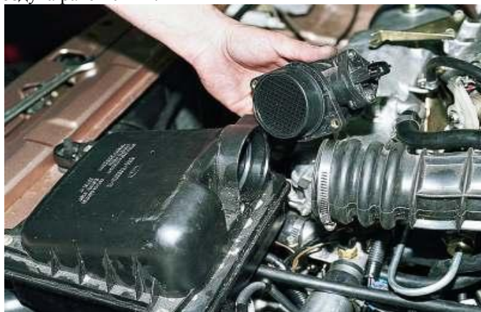
Рис. 179 – Место установки датчика массового расхода воздуха (ДМРВ)
