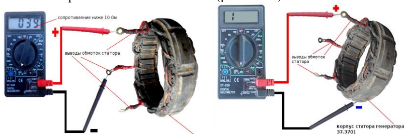
Рис. 193 - Схема проверки обмотки статора:
