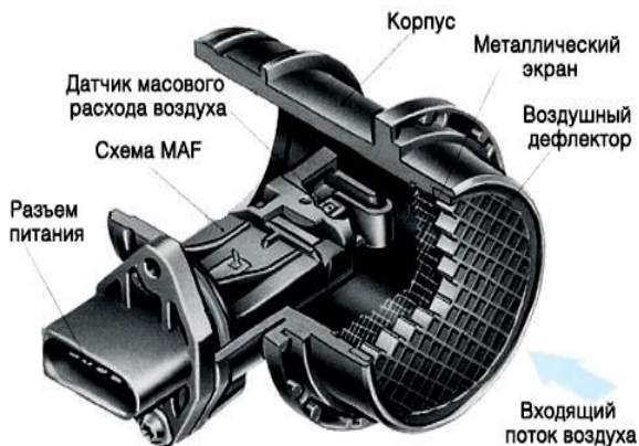
Рис. 180 - Устройство датчика массового расхода воздуха (ДМРВ)
