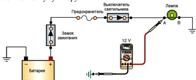
Рис. 185 - Схема проверки напряжения на стороне питания устройства
