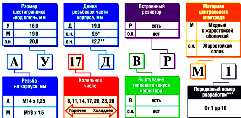
Рис. 110 - Маркировка свечей зажигания
