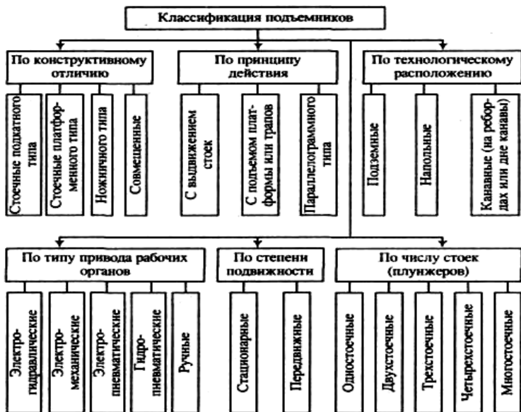
Рис. 103 – Классификация подъемников
