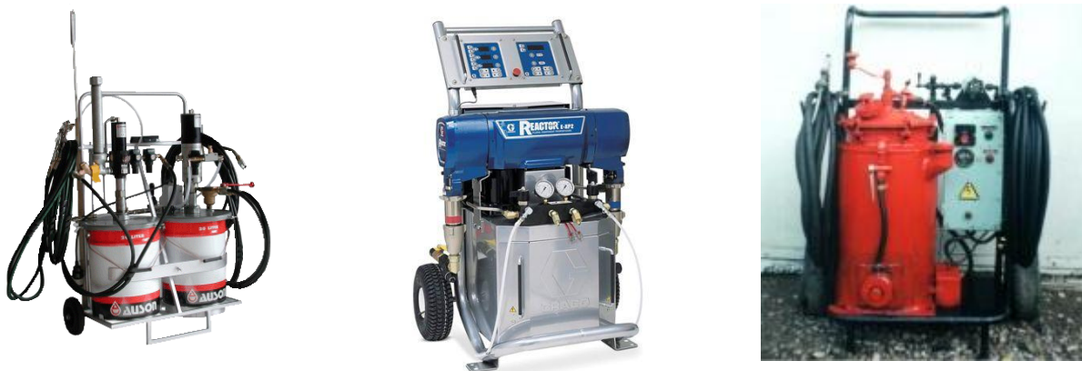
Рисунок 6.10 Установки для нанесения антикоррозионных покрытий
