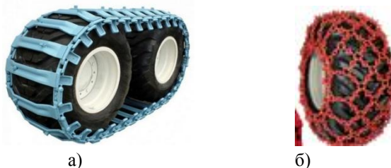
Рис. 128 - Траковые цепи: а - таврового типа; б — ромбовидного типа
