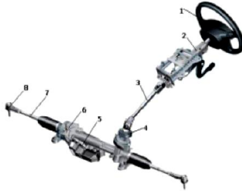
Рис. 33 - Рулевое управление легкового автомобиля: 1- рулевое колесо; 2 - рулевая колонка; 3- карданный вал; 4-датчик крутящего момента на рулевом колесе; 5-электроусилитель руля; 6-рулевой механизм; 7-рулевая тяга; 8-наконечник рулевой тяги с шаровым шарниром
