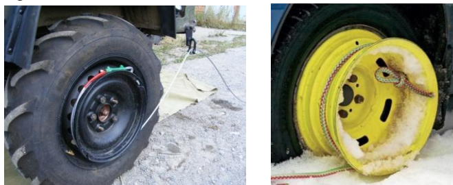
Рис. 138 - Барабаны, используемый для самовытаскивания Барабан надевают на ступицу ведущего колеса. На шейку ступицы накладывают два полукольца, уравнивающие наружный диаметр ступицы по длине. Трос закрепляют крюком за вырез в диске колеса и затем двумя-тремя витками наматывают на барабан.
