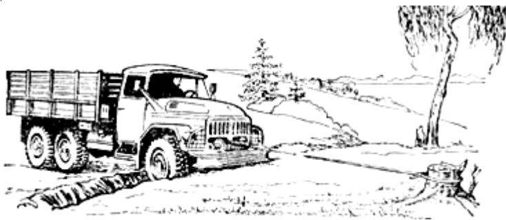
Рис. 141 - Самовытаскивание лебедкой автомобиля
