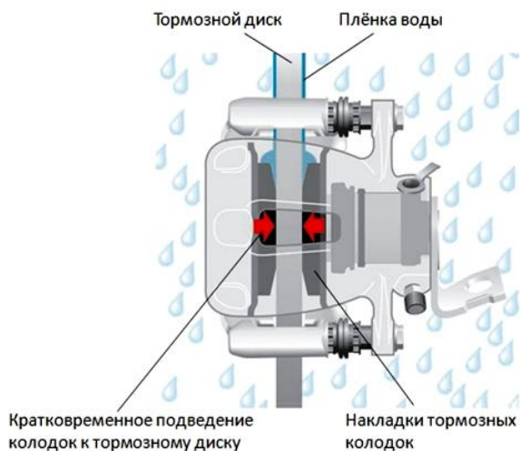
Рис. 74 - Принцип работы системы BSW
