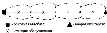
Рис.37 - Схема расположения линейных пунктов на конце автомобильной линии
