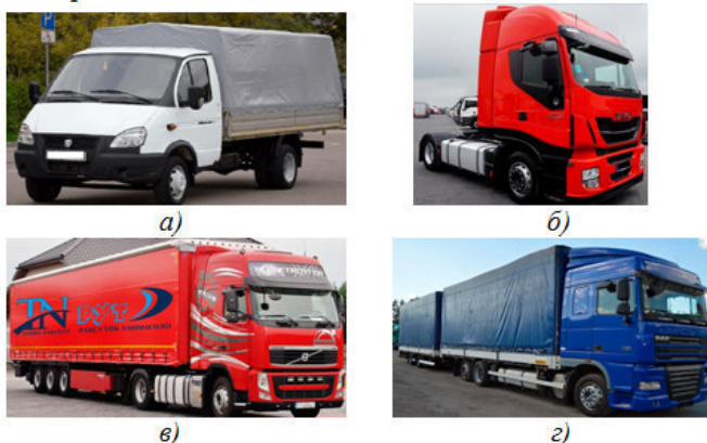
Рис. 14 - Типы грузовых автомобилей по составу:
