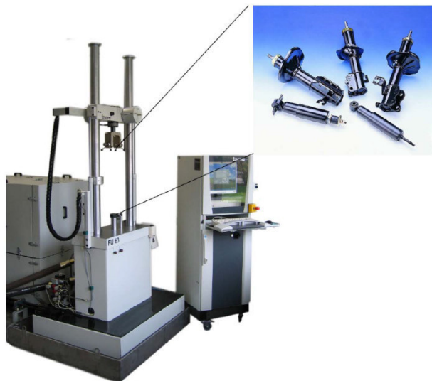
Рисунок 118 - Стенд испытаний амортизаторов производства АО "Аврора"
