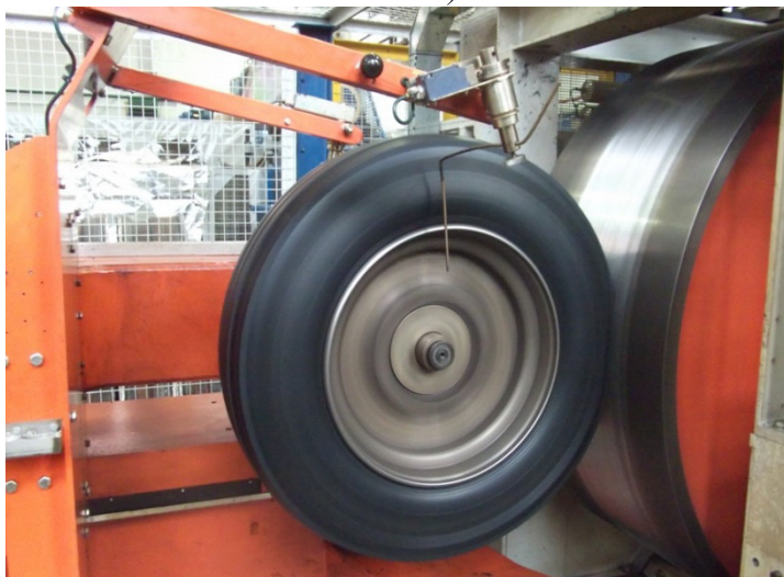
Рисунок 140 - Стенд для определения сопротивления качению шин:
