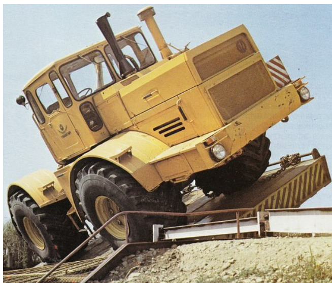
Рисунок 156 - Испытания трактора на поперечную устойчивость
