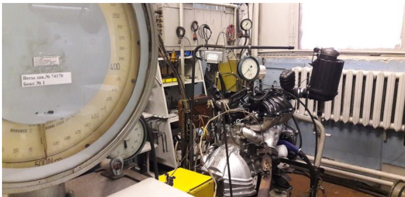
Рисунок 92 - Испытательный стенд двигателей УМЗ Ульяновского моторного завода
