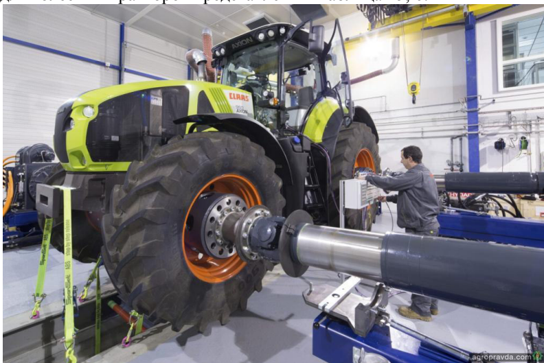
Рисунок 75 - Тормозной стенд испытательного центра Claas
