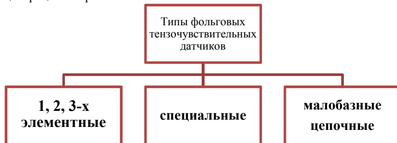
Рисунок 22 - Типы фольговых тензочувствительных датчиков
