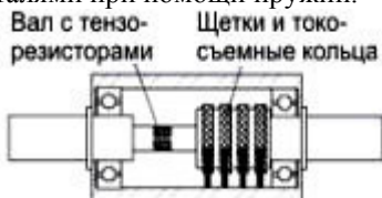
Рисунок 69 - Схема датчика крутящего момента на полуоси автомобиля
