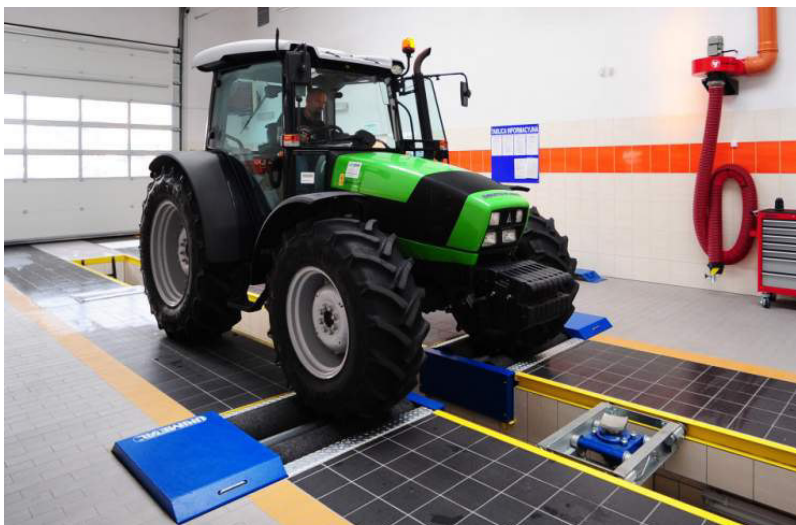
Рисунок 76 - Тормозной стенд RHE-30/10
