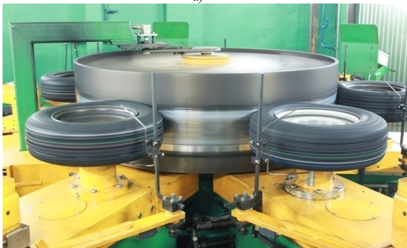
Рисунок 142 - Испытательные стенды для динамических испытаний шин легковых и легких грузовых автомобилей:
