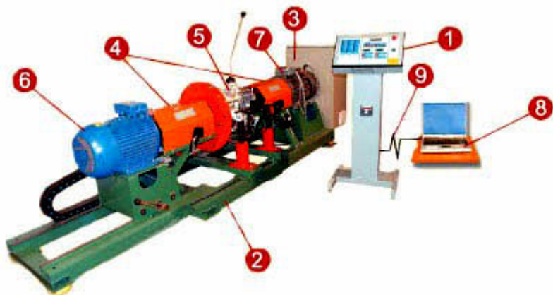
Рисунок 105 - Стенд испытания МКП Фольксваген:
