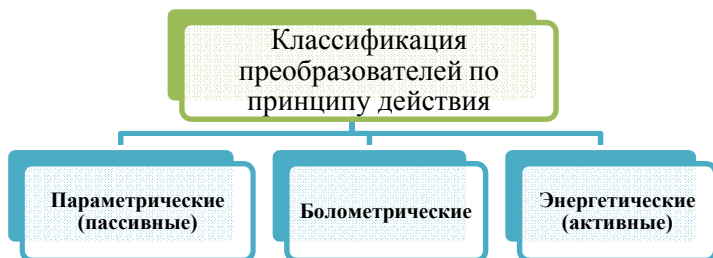
Рисунок 10 - Классификация преобразователей по принципу действия
