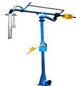
Рис. 7 – Устройство верхнего налива
