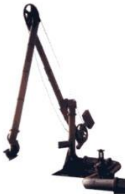
Рис. 1.55 – Установка УРУ-250 для налива и слива нефтепродуктов в танкеры и баржи
