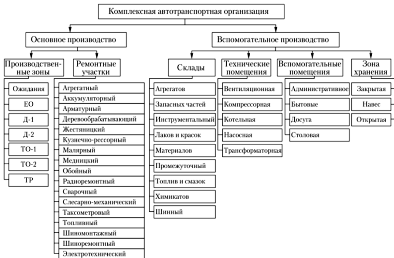
Структура производственных подразделений и помещений комплексной АТО
