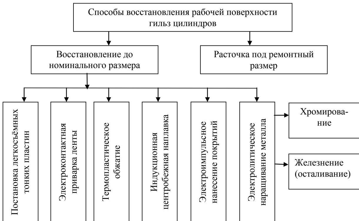
Рисунок 1.4 – Способы восстановления рабочей поверхности гильз цилиндров
