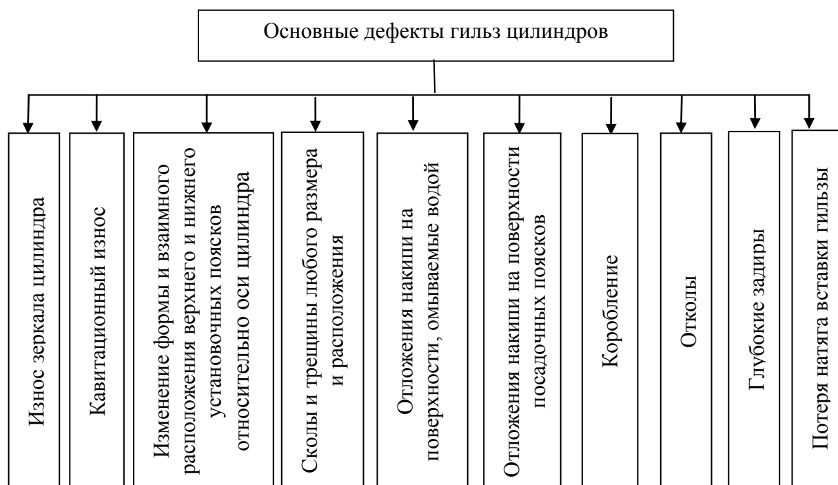
Рисунок 1.3 – Основные дефекты гильз цилиндров
