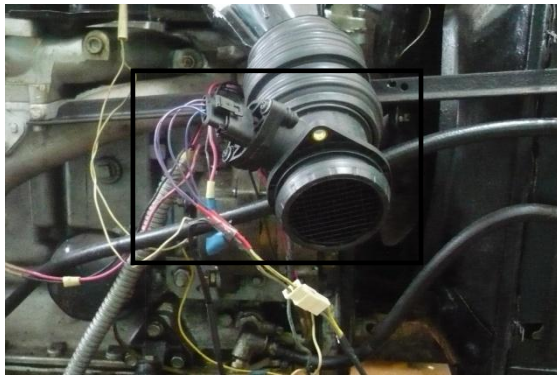
Рисунок 4.24 – Места установки датчиков контроля расхода объема воздуха: а) датчик массового расхода воздуха; б) датчик разряжения
