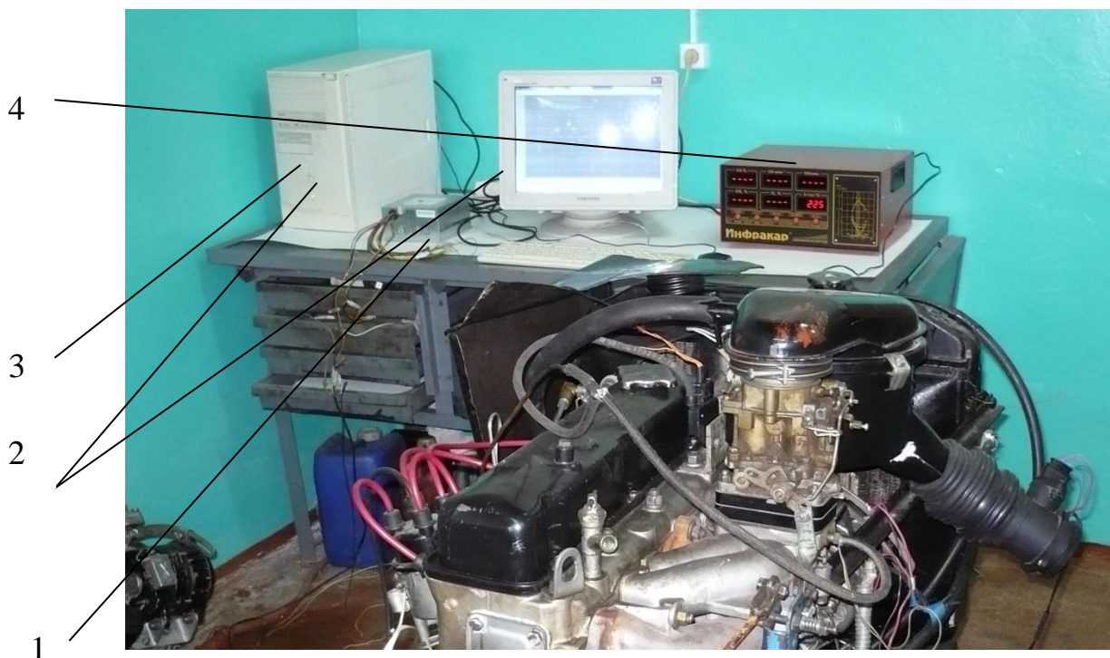
Рисунок 4.20 – Измерительно-регистрационный комплекс: 1 – блок питания; 2 – системный блок с монитором; 3 – АЦП; 4 – газоанализатор Инфракар М1-0
