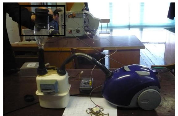
Рисунок 4.25 – Способы тарировки: а) датчик разряжения BOSCH 4513829; б) датчик массового расхода воздуха BOSCH 0 280 218 037
