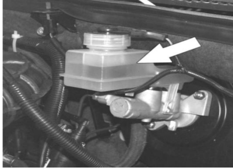
Рисунок 1 Проверка уровня тормозной жидкости
