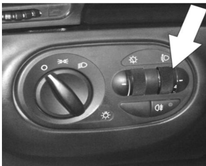
Рисунок 3 Проверка работы электрокорректора фар
