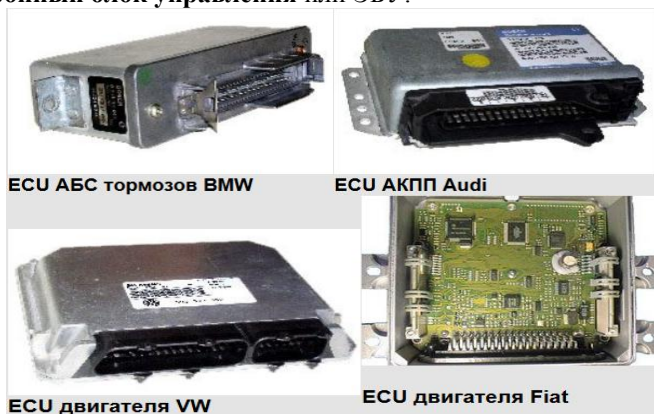
Рисунок 1 – Типы электронных блоков управления
