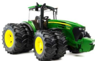
Рис. 3.2 – Трактор John Deere оснащенный сдвоенными колесами
