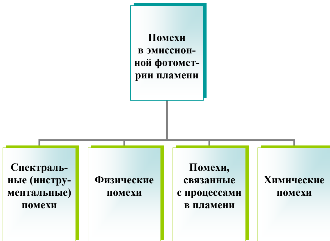
Рис. 39. Помехи в эмиссионной фотометрии пламени.
