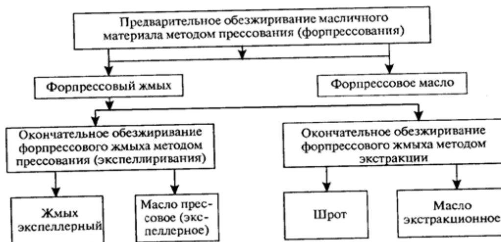
Схема получения растительного масла
