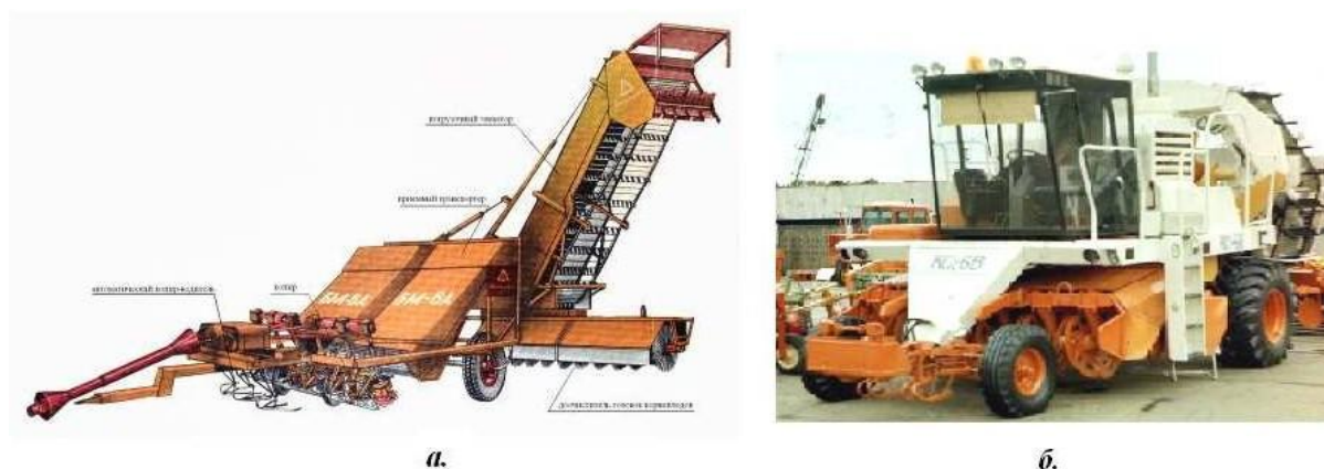
Рис. 7.2. Машины для уборки сахарной свеклы: а – ботвоуборочная машина БМ-6Б;
