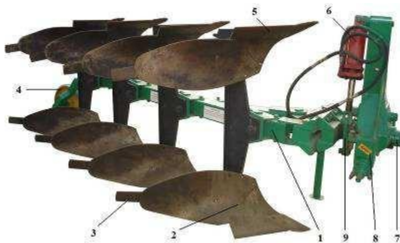
Рис. 2.1. Плуг оборотный ПО-(3+1)×45: 1 – рама; 2 – корпус правооборачивающий; 3 – перо; 4 – колесо; 5 – корпус левооборачивающий; 6 – гидроцилиндр; 7 – ось рамы; 8 – навеска; 9 – рычажно-секторный механизм.
