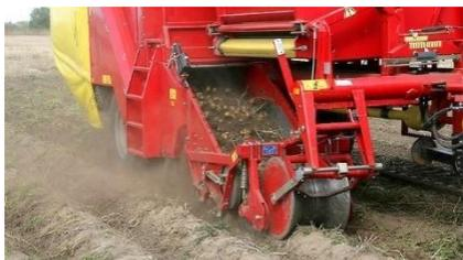
При раздельной уборке картофель выкапывается картофелеуборочными машинами с валкообразователем УКВ-2, который укладывает клубни в валок, в зависимости от урожайности в этот же валок могут быть уложены клубни с двух или четырех соседних рядков. Валки подбираются комбайном ККУ-2 «Дружба», из
