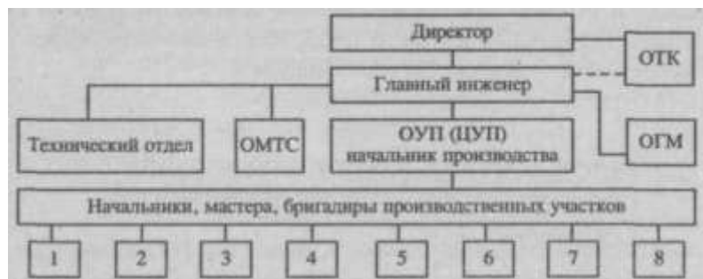
Рис. 3 - Схема организации производства ТО и ТР подвижного состава при агрегатно-участковом методе. На схеме сплошными линиями показаны более распространенные соподчинения, пунктирными — менее
