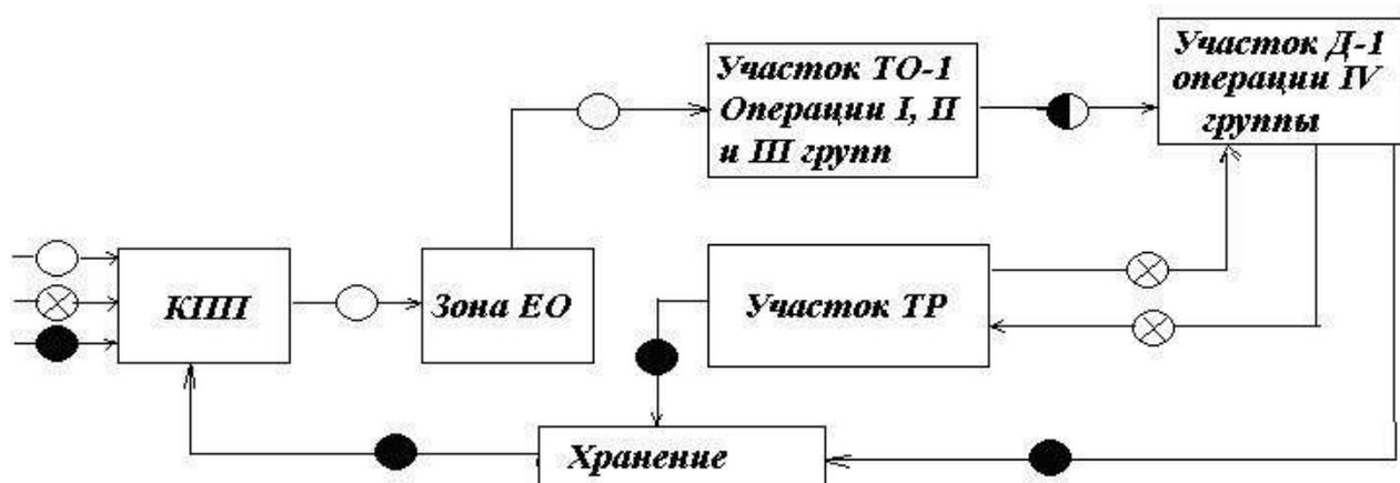
Рисунок 11 - Схема организации технологического процесса ТО-1 с применением диагностирования
