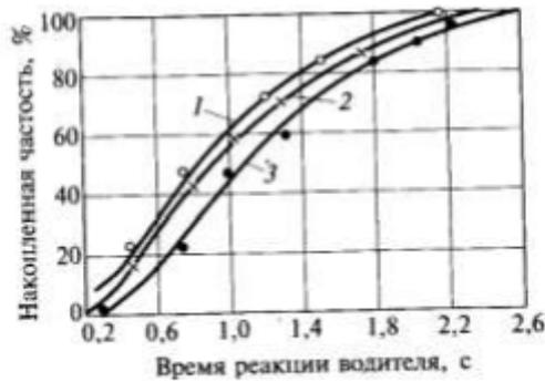
Рис. 5.15. Время реакции водителя на характерных участках дорог в горной местности: 1 - движение на спуске; 2 - движение на подъеме; 3 - равнинные участки
