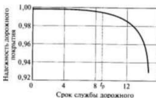
Рис. 4.1. Изменение надежности дорожной одежды в зависимости от срока службы: t_p - расчетный срок службы дорожной одежды
