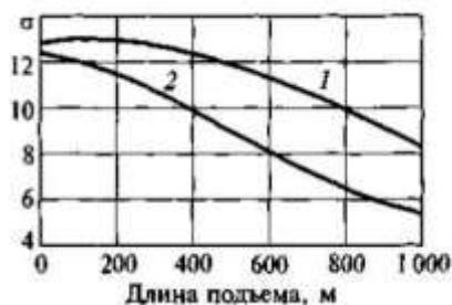
Рис. 5.14. Зависимость среднего квадратического отклонения скоростей движения от длины подъема: 1 - i = 30 ‰ ; 2 - i = 80 ‰
