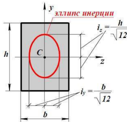
Рисунок 10.6 – Эллипс инерции прямоугольного сечения
