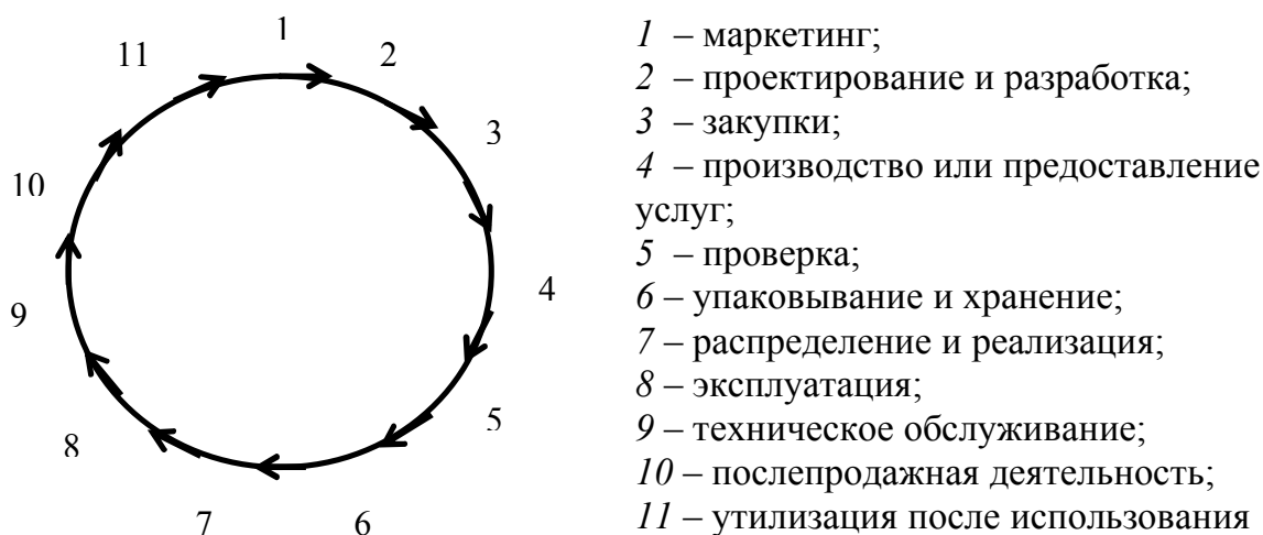
Рис. 1.2. Процессы жизненного цикла продукции
