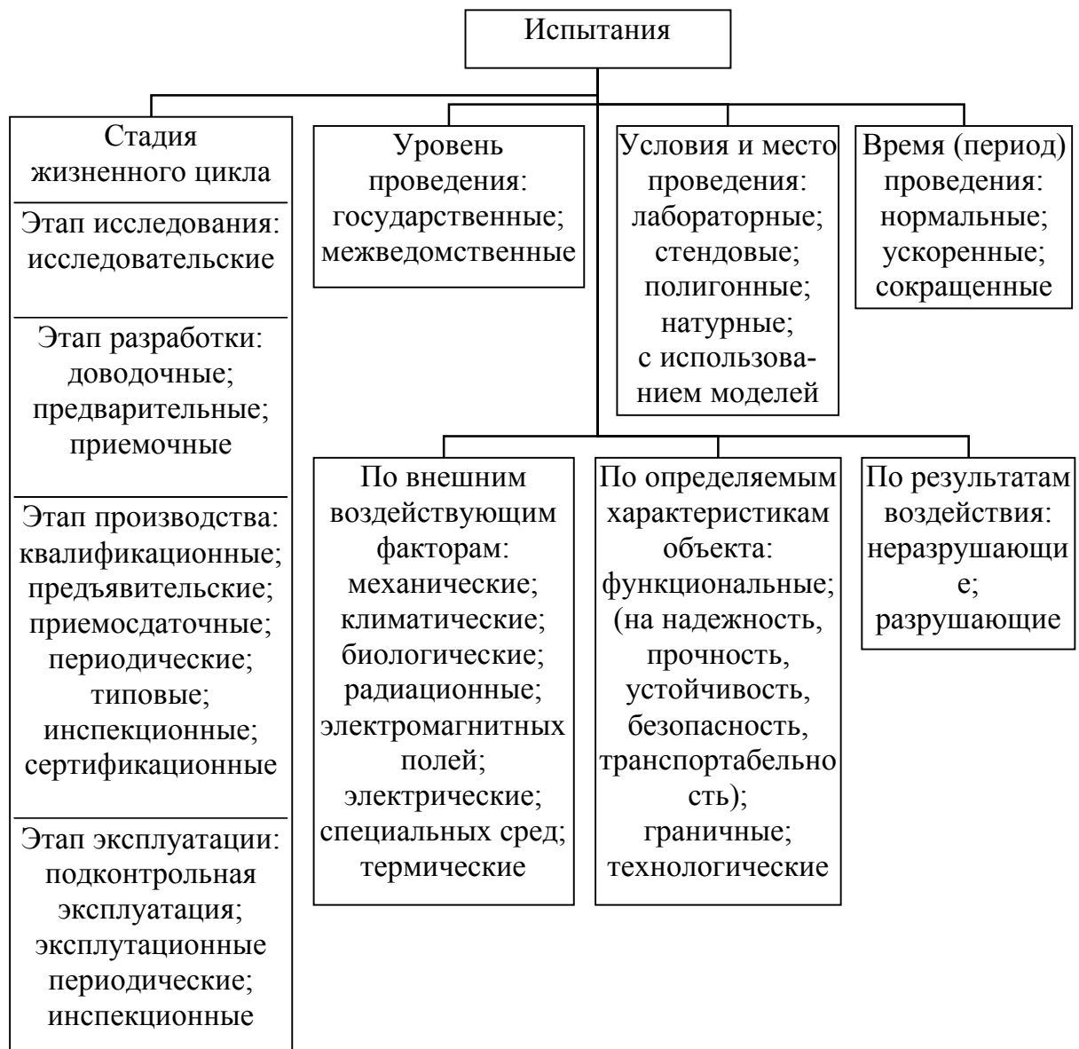
Рис. 16.1. Классификация основных видов испытаний
