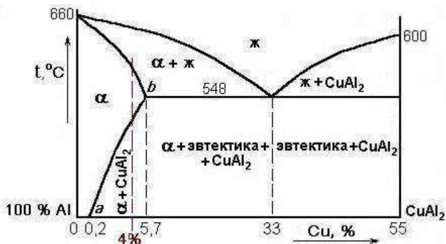
Рис. 2.99. Диаграмма состояния алюминий – медь
