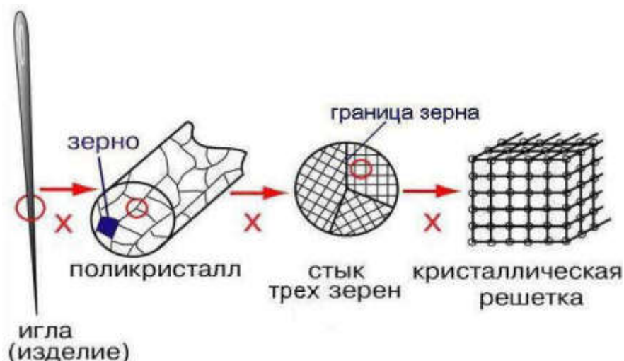
Рис. 2.2. Схема кристаллического строения металлов
