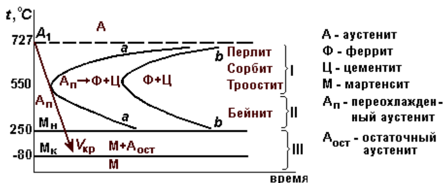
Рис. 2.78. Диаграмма изотермического превращения аустенита для стали с 0,8 % С
