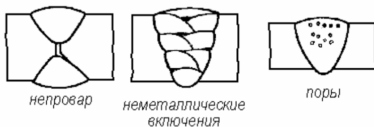
Рис. 1.68. Дефекты сварных соединений
