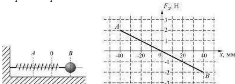
На графике представлена зависимость проекции силы упругости пружины на положительное направление оси X от координаты шарика. Работа силы упругости (в мДж) при смещении шарика из положения А в положение В составляет ...
