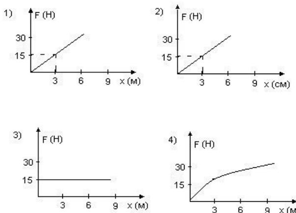
**A2.** Под действием силы 3 Н пружина удлинилась на 4 см, а под действием силы 6 Н на 8 см. С какой силой надо подействовать на пружину, чтобы ее удлинение составило 6 см?
