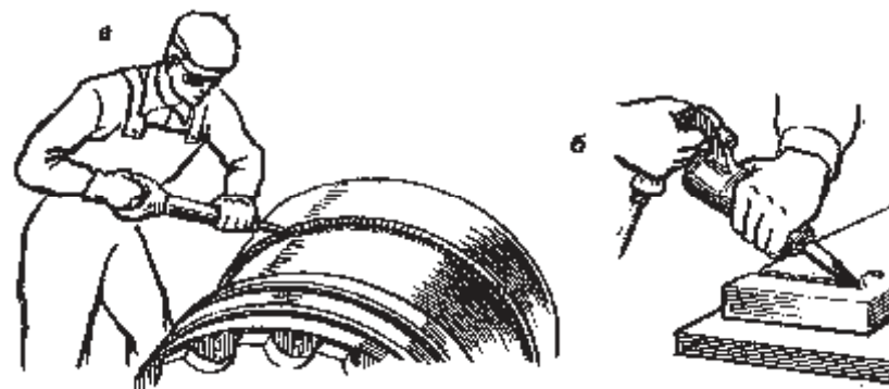
а – работа пневматическим рубильным молотком;
