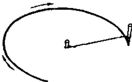
Рисунок 1.1 – Шнур для проведения окружности
