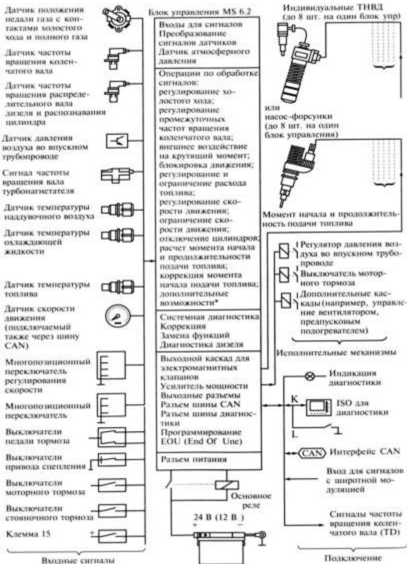
Рисунок 12 – Схема электронной системы управления дизеля
