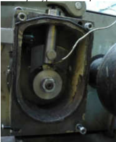
Рисунок 15 – Общий вид испытательной камеры с установленными образцами и термопарой
