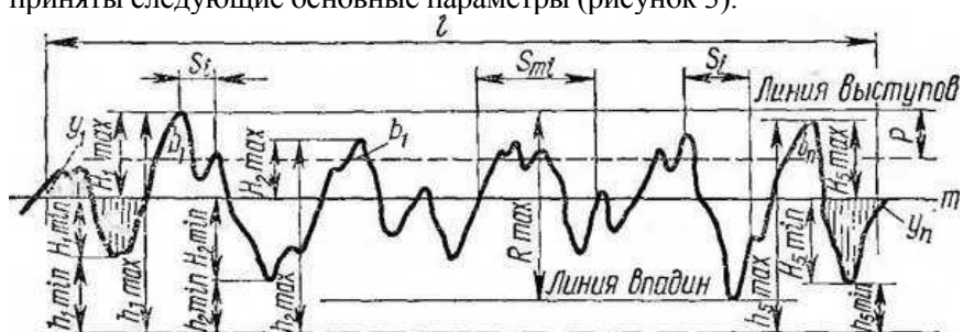
Рисунок 3 - Основные параметры для оценки шероховатости по ГОСТ 2789—73
