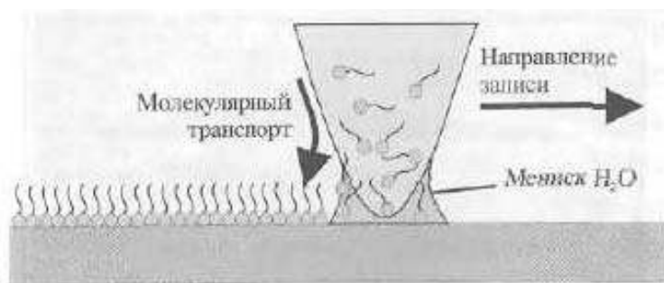
Схема проведения зондовой нанолитографии с помощью «погруженного пера»
