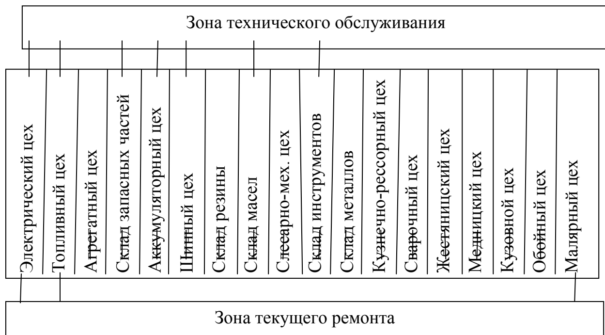
Рисунок 2.5 – структурная схема комплектования цехов и их связи с производственными зонами
