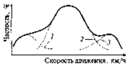
Рис. 5.8. Полимодальная кривая распределения: 1, 3 - соответственно для медленно- и быстро движущейся части транспортного потока; 2 - для большинства автомобилей транспортного потока
