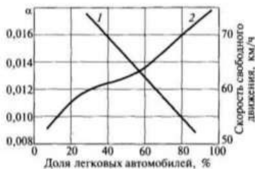
Рис. 5.11. Зависимость коэффициента \alpha (1) и скорости свободного движения u_0 (2) от состава транспортного потока (доли легковых автомобилей в транспортном потоке)
