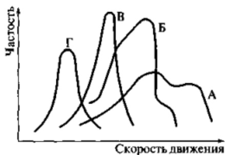
Рис. 5.3. Кривые распределения значений скорости движения при разных уровнях удобства движения А - Г
