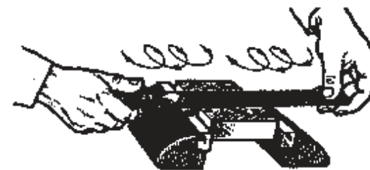
Рисунок 1 - Припиливание поверхности с проверкой на «краску»
