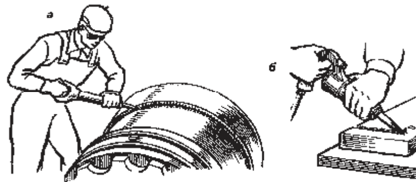
а – работа пневматическим рубильным молотком;
