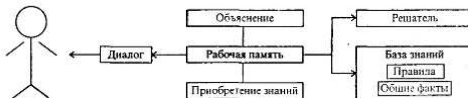
Рис. 2.27. Схема обобщенной экспертной системы
