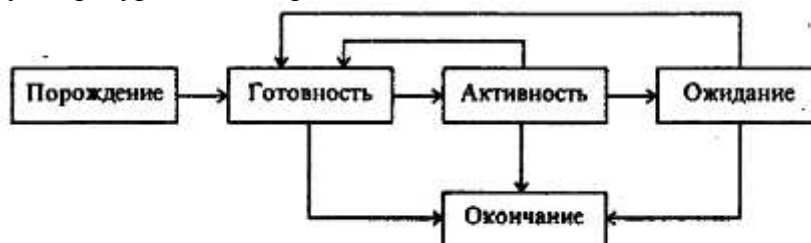
Рис. 2.1. Граф состояний переходов процесса из одной фазы в другую
