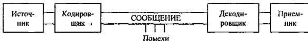
Рис. 1.5. Процесс передачи сообщения от источника к приемнику
