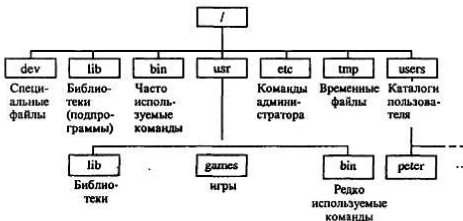
Рис. 2.2. Иерархическая система каталогов
