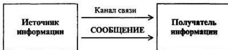
Рис. 1.3. Схема передачи информации
