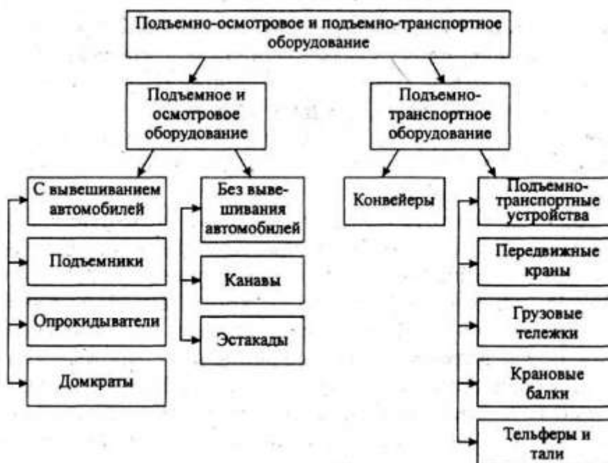
Рис. 1.1. Классификация подъемно-осмотрового и подъемно-транспортного оборудования
