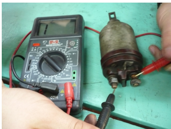
Рисунок 3.7 – Проверка втягивающего реле стартера
