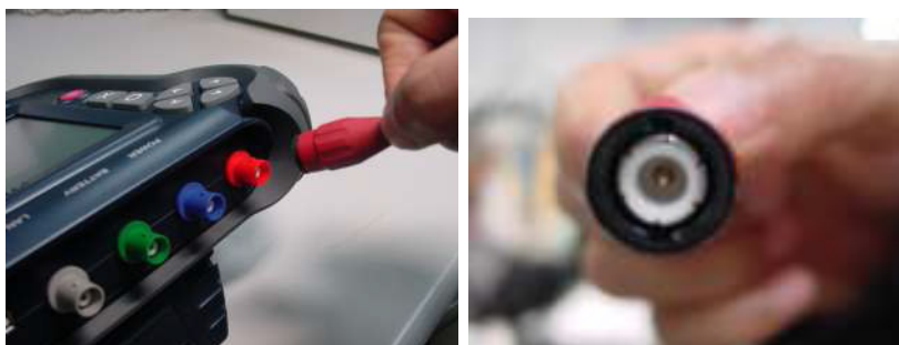
Рисунок 5.7 – Подключение осциллографа к корпусу сканера
