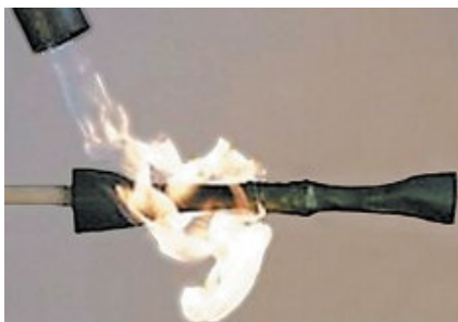
Рисунок. 6.7. Термоусадочная трубка, обрабатываемая пламенем горелки
