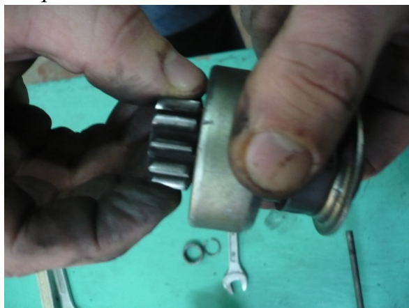
Рисунок 3.5 – Проверка шестерни привода
