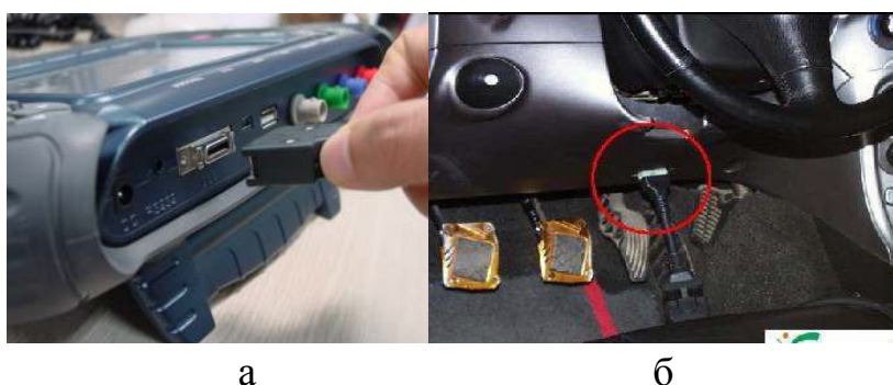
Рисунок 5.3 – Подключение сканера к коннектору автомобиля а – подключение DLC кабеля к сканеру; б - подключение DLC кабеля к коннектору автомобиля
