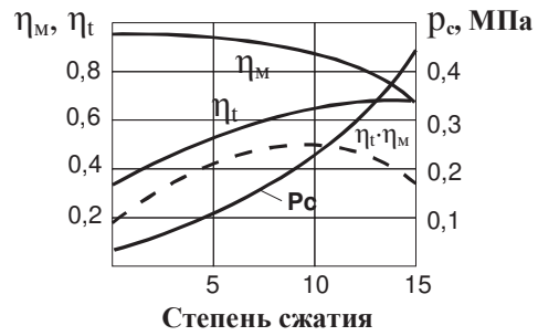
Рис.17.1. Влияние степени сжатия на параметры ДВС (P c – давление конца сжатия, η м η т – механический и термический КПД).
