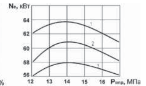
Рис.16.23. Влияние давления впрыска форсунки на эффективную мощность при разных положениях над уровнем моря: 1 – H = 850 м; 2 – H = 1600 м; 3 – H = 2000 м.
