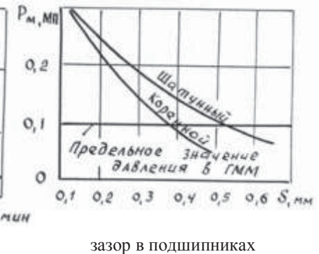
Рис. 18.13. Влияние зазора в подшипниках на давление в главной масляной магистрали.
