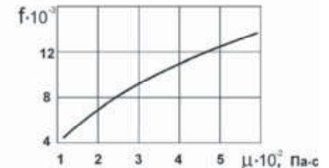
Рис.16.17. Влияние вязкости масла М10Г₂ на коэффициент трения в подшипниках.
