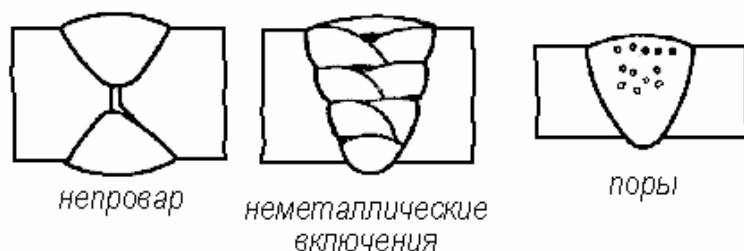
Рис. 1.68. Дефекты сварных соединений
