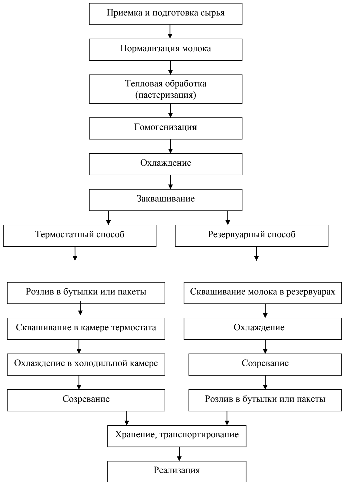
Рисунок 11.2.1. Схема производства кисломолочных напитков
